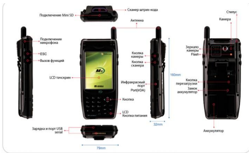
Рисунок 2. Основные элементы терминала Mobile Comria M3
